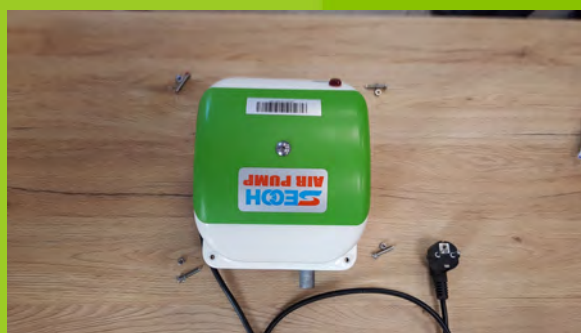
Dmychadlo odpojíme ze sítě el. energie.
