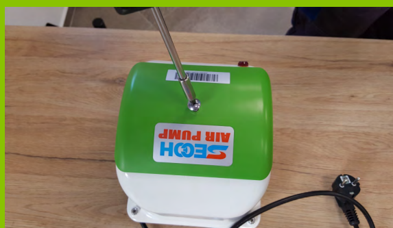
Pomocí křížového šroubováku odmontujeme horní víko dmychadla.
